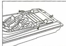
1. Установите скоростную лодку на платформу, снимите крышку.
