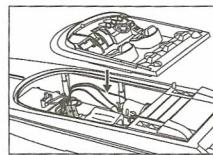
Установите затвор верхней части лодки в корпус согласно рисунку, полностью задвиньте его внутрь и нажмите на крышку, затем поверните кнопку затвора вверх. (Снимайте верхнюю часть лодки в обратном порядке).
