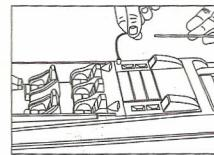
Установите принимающий провод в канал на антенну, затем установите антенну в отверстие на лодке.
